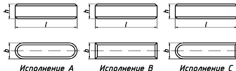
Рисунок 1. Виды исполнения призматических шпонок
