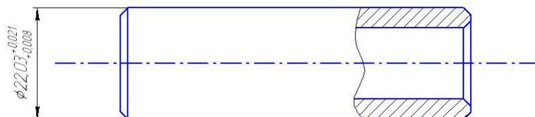
Рисунок 1 – Палец поршневой с указанием предельных размеров
